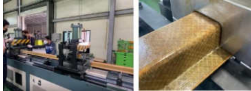
Fig. 6 멀티셀 구조 복합재 인발부품 시험 생산
